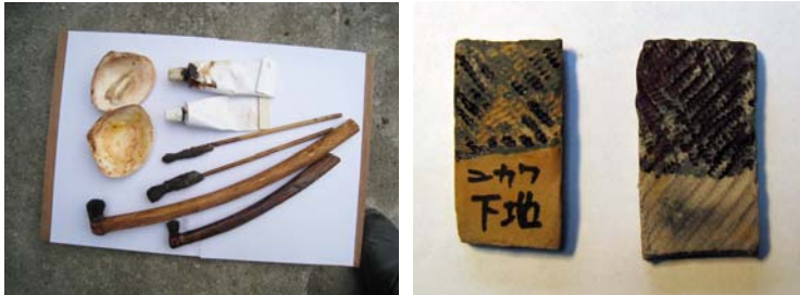
(写真) 左：塗装に使用する道具 右：剥離したテストピース（膠下地）
